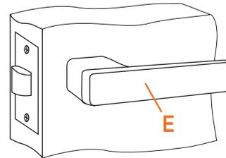
\* Установку ручки рекомендуется производить после окончания строительных работ во избежание попадания строительной пыли, краски, ацетона и т.п.
