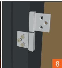
8. Установить петли на дверную коробку. Проверить, что они находятся на одной оси с коробкой, а затем закрепить шурупами, проверив надёжность крепления.
