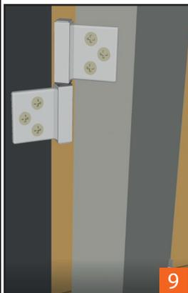
9. Переместить дверь к петлям, установить её на упор между полом и дверью. Проверить, что петли находятся заподлицо с поверхностью двери, затем закрепить шурупами, проверив надёжность крепления.
